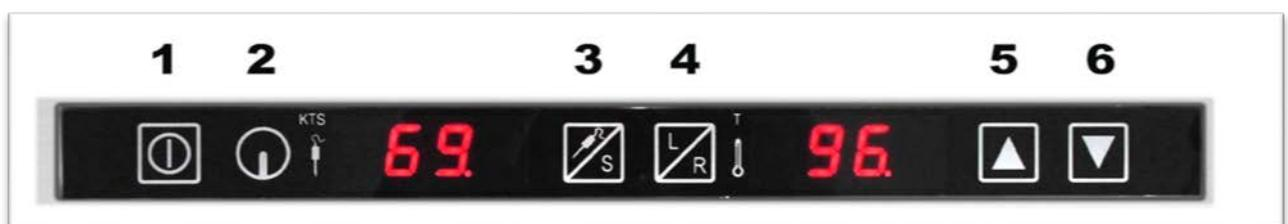
Kurzes Betätigen der Taste 2 stellt die Temperatur sofort auf 68°C. Mit Taste 3 kann der Kerntemperaturfühler eingeschaltet werden, und die Kerntemperatur wird informativ in der linken LED Anzeige angezeigt. Der Kerntemperaturfühler hat im Warmhaltebetrieb keinen Einfluss auf die Temperaturregelung. Das Betätigen der Taste 4 lässt die aktuelle Garraumtemperatur für kurze Zeit in der rechten LED Anzeige anzeigen.
